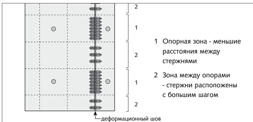
Расположение стержней в зависимости от величин поперечных сил
