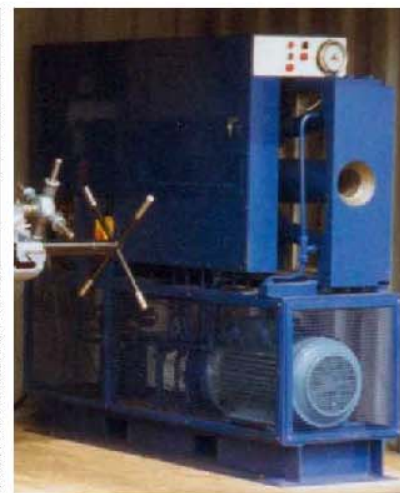
ЧЕРТЕЖ 1: УСТАНОВОЧНАЯ МАШИНА ДЛЯ КОНТРОЛЯ НАРЕЗАННОЙ РЕЗЬБЫ
